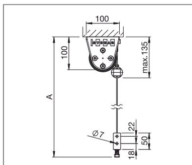
S4110 Montaje al techo con cable guía
