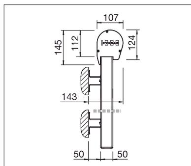
VS4300 Fijado pared con caja redonda y perfil guía
