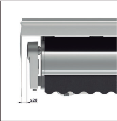
Espacio mínimo recomendado entre las tapas del tejadillo y los soportes >20mm
